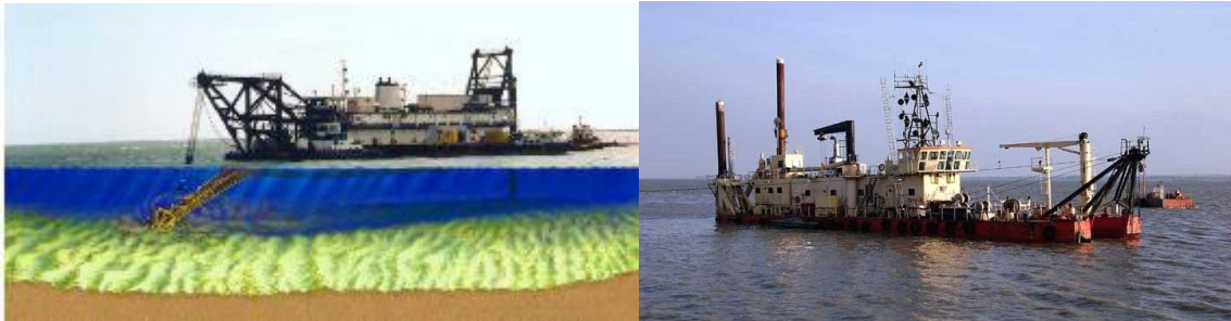
Figure 2. Vue d'artiste du fonctionnement d'une drague aspiratrice stationnaire (US ARMY, à gauche) et DAS André Legendre du GPMNSN (à droite)
