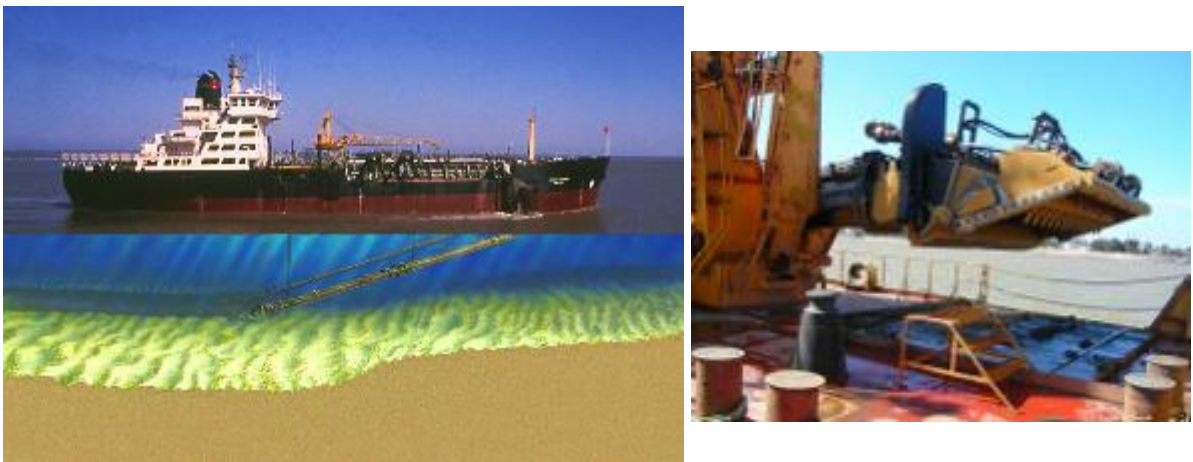
Figure 1. Drague en Marche (US ARMY - à gauche) et tête d'élinde de la DAM Samuel de Champlain (à droite)
