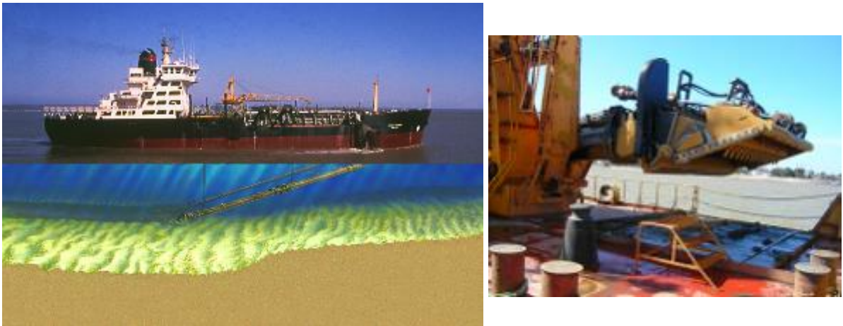
Figure 2. Drague en Marche (US ARMY - à gauche) et tête d'élinde de la DAM Samuel de Champlain (à droite)
