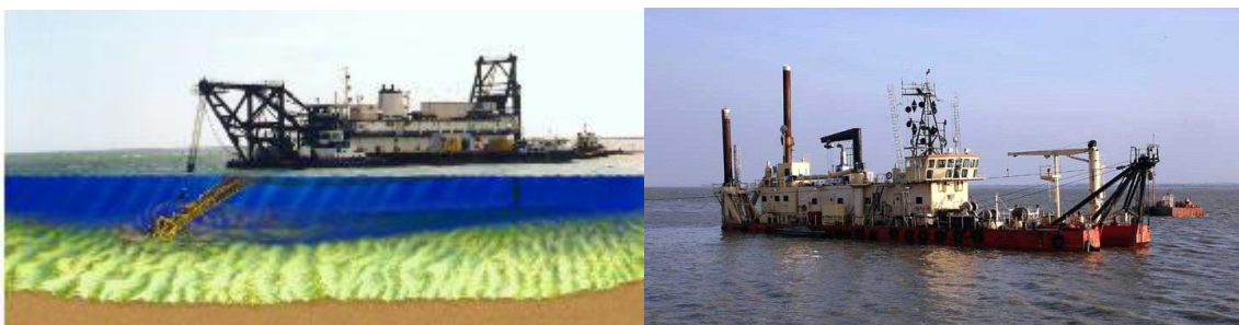
Figure 4. Vue d'artiste du fonctionnement d'une drague aspiratrice stationnaire (US ARMY, à gauche) et DAS André Legendre du GPMNSN (à droite)
